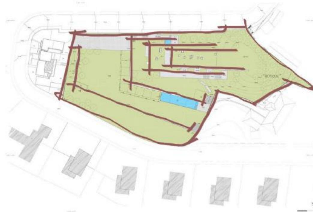
"POR CONTA DA GRANDE INCLINAÇÃO DO TERRENO DECIDIMOS NÃO FAZER UM GRANDE VOLUME ÚNICO POUSANDO SOBRE A COLINA, MAS SIM FRAGMENTAR A EDIFICAÇÃO EM CINCO TERRAÇOS, DELIMITADOS POR MURÓS DE CONTENÇÃO. CADA PLATAFORMA POSSUI UMA FUNÇÃO. NA BASE INFERIOR, UMA PLANTAÇÃO DE FRUTAS; NO SEGUNDO TERRAÇO, UMA PISCINA; NO TERCEIRO, AS PRINCIPAIS FUNÇÕES DA CASA; NO QUARTO, OS DORMITÓRIOS; E NO ÚLTIMO TERRAÇO, COMO PROLONGAMENTO DA COLINA, PLANTAMOS UM BOSQUE". (EL CROQUIS, 2009, p. 50).
